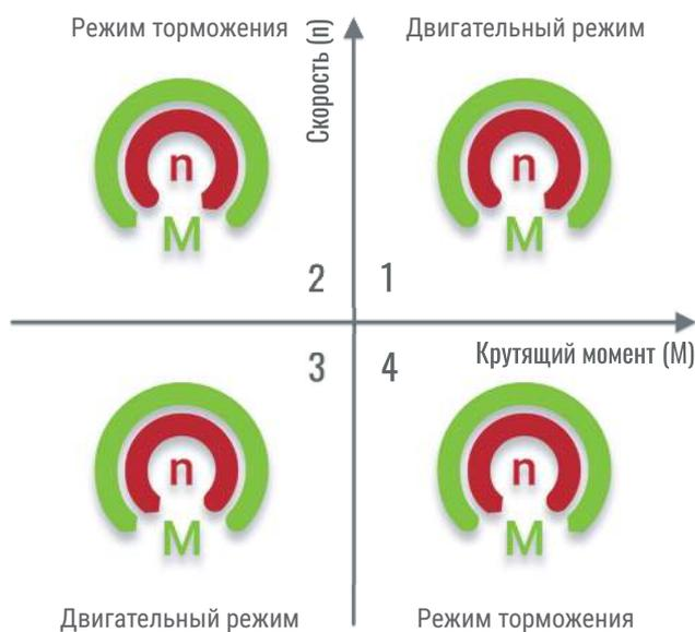
Опционально могут применяться силовые ячейки с выпрямительным мостом на основе **IGBT – транзисторов**, которые позволяют возвращать электроэнергию при переходе электродвигателя в генераторный режим.
