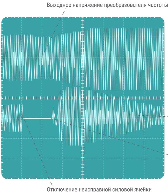
На данном рисунке представлена осциллограмма напряжения и тока на электродвигателе в момент байпаса неисправной силовой ячейки.
