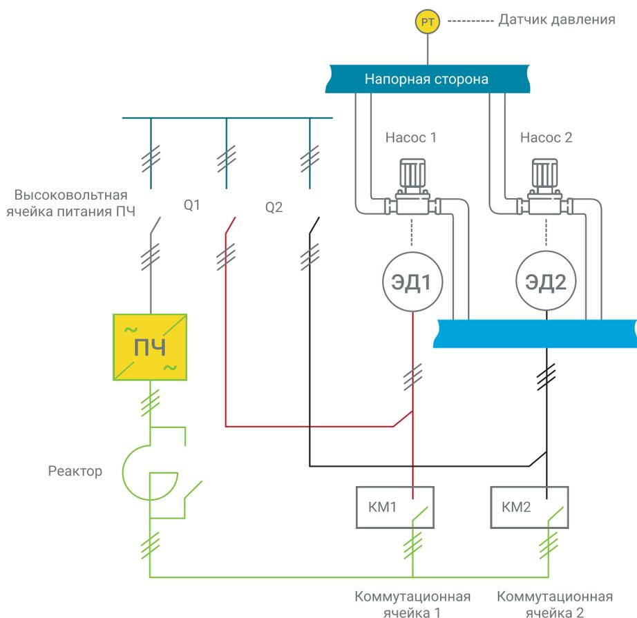
Условная однолинейная схема управления двух насосных агрегатов от ПЧ с опцией «Синхронизация на сеть»
