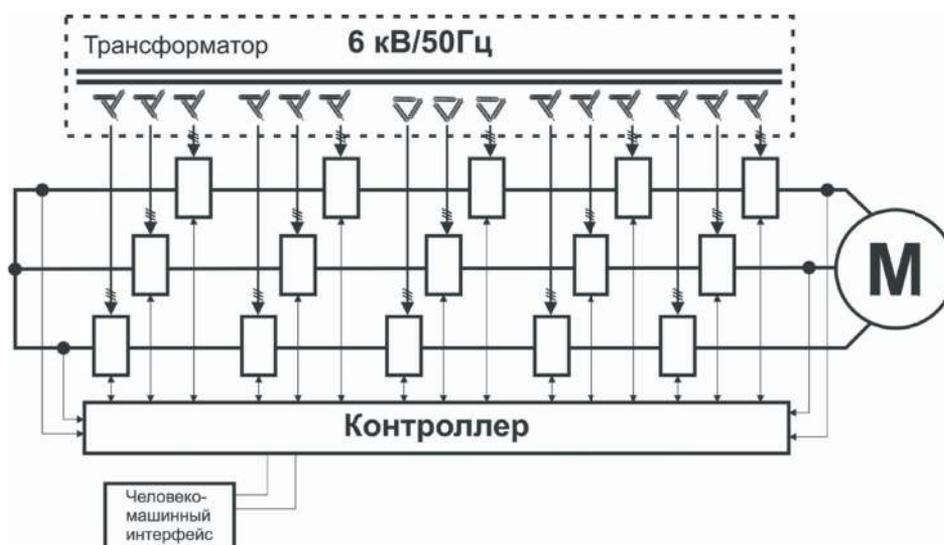
Выходное напряжение RU-DRIVE VFD формируется путем суммирования выходных напряжений силовых ячеек на основе **IGBT-модулей** низкого напряжения, соединенных друг с другом последовательно и равных по количеству для каждой фазы. Количество используемых силовых ячеек определяется необходимым напряжением на выходе преобразователя частоты.
